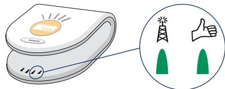
**6** Il **ponte radio** è realizzato. **Qualità del collegamento:** ottimale (verde) o media (verde lampeggiante)
