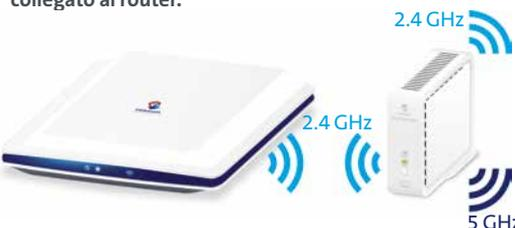
**Attenzione:** se viene disattivata la WLAN del router il ripetitore lampeggia di rosso. Succede ad es. Quando è stata configurata una programmazione oraria per la WLAN (con orari di accensione e spegnimento automatici).
