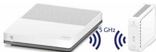
Gli Internet-Box standard e plus supportano la rete a 5 GHz e il ripetitore è nel raggio di portata.
