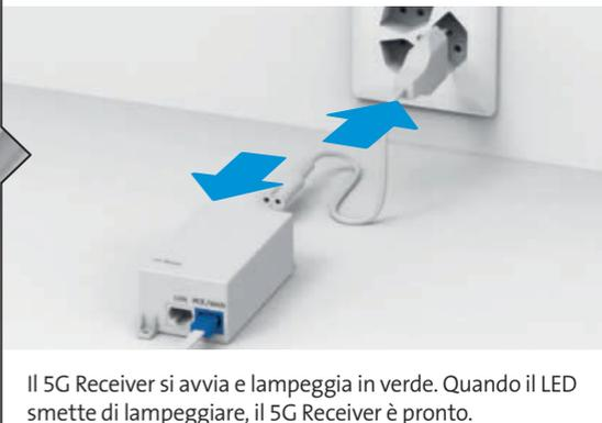
Il 5G Receiver si avvia e lampeggia in verde. Quando il LED smette di lampeggiare, il 5G Receiver è pronto.
