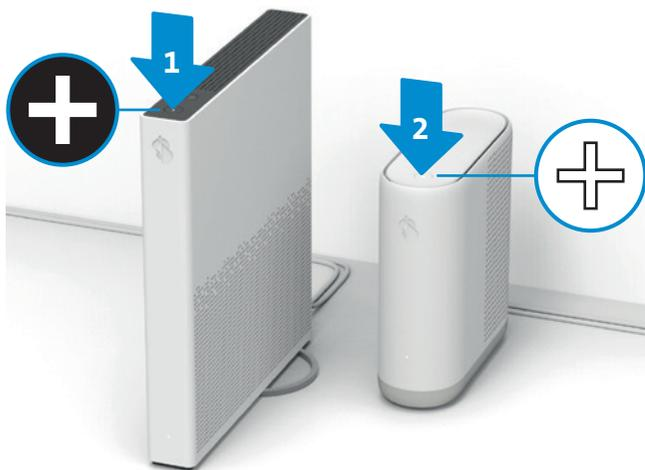
**Marche à suivre:** appuyez sur les 2 touches+ (Internet-Box et WLAN-Box 3) d'ici 2 minutes pour coupler automatiquement les 2 appareils.
