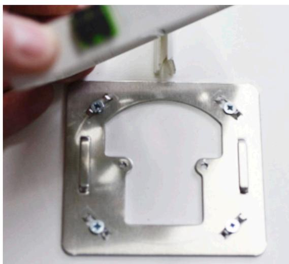
Bei der anschliessenden Wiedermontage ist es wichtig, dass die Dose hörbar wieder einrastet. Dabei ist zu beachten, dass das Glasfaserkabel beim Kabelkanal nicht eingeklemmt wird. Zudem ist die Socket-ID wieder am richtigen Ort anzubringen.
